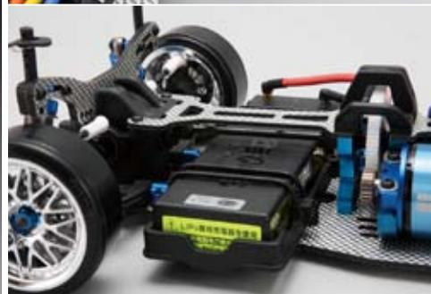
シャフトドライブ ドリフトカーのニューモデル“DPM”がいよいよ新登場！ドリフト走行に最適な重心バランスを獲得すべく、モーターをフロントミッドに搭載。新型ギヤボックスで駆動系をモデファイし、ストレートパックを横置き搭載にするなど、徹底的な重量配分にこだわりました。
