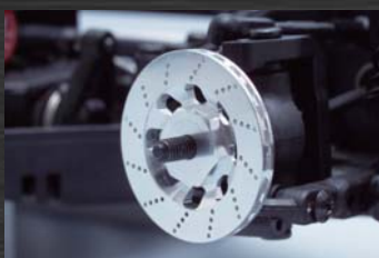
アルミ製 ベンチレーテッド ディスクホイールハブ
