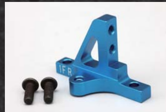
フロントバルクヘッドキャップ Iアーム取付位置 3.5mm ワイド (左右) BD-302FL1 / BD-302FR1 各 ¥1,700
