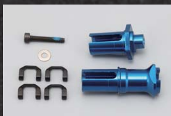
FCD スタンダード ソリッド アクスル (アルミ製 プロテクトタイプ)
