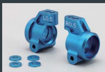
アルミ製 リアハブキャリア (トーン0.5度)
