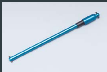
センターワンウェイ SD-644TS ¥3,480 センターシャフトにワンウェイベアリングが装着され、フロントへのブレーキをカットする。
