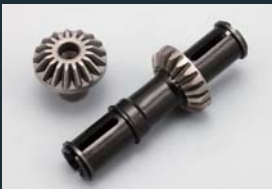
フルカウンター ソリッドアクスル セット (リヤ 1.8 倍、リヤ 2.0 倍)
