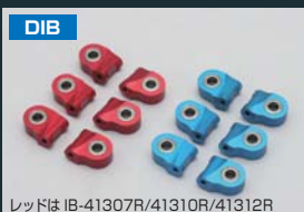
DIB アルミ製 ロアキャスターブロック (7 度 10 度 12 度 ブルー/レッド) IB-41307/41310/41312 各 ¥1,680 フロント C ハブの代わりに取り付け、ステアリングの可動域を広げる。キャスターは 7~12 度の 3 種。
