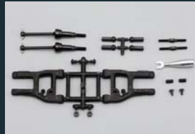
深リムホイール専用 リヤ サスペンション セット (φ2ピン仕様)
